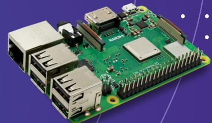
Cuenta con una unidad de control basada en el sistema embebido **Raspberry pi3 B+**, que se encarga de la medición de voltajes y corrientes; también gestiona la comunicación de las fuentes de alimentación del sistema STS, controlando de forma independiente cada salida de voltaje.
