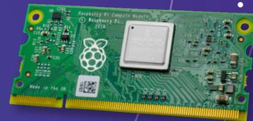
Este módulo de computador **Raspberry CM3+** es compatible con DDR2-SODIMM. Contiene un procesador, una memoria y eMMC Flash. Tiene un diseño SODIMM de 200 pines y contiene 32 GB de memoria flash eMMC incorporada. Es encargado del control global de los periféricos de la board de control (HDMI, ETHERNET, GPIOs, SERIALES).
